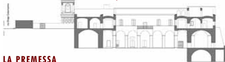
SOPRA: la pianta del progetto al piano chiostro, dove verranno ubicate diverse sale destinate ad ospitare attività culturali e religiose; SOTTO: la sezione trasversale con il campanile della chiesa di Madonna delle Grazie, il chiostro e l'area verde a valle del monastero con i tre livelli di box sottostanti; A DESTRA: la ricostruzione computerizzata della stessa area, sono visibili sia i due accessi pedonale ai box che quello carrabile.
